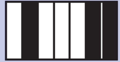
Abbildung 2: Schema der Ziffer 4 im Format A. Jeder schwarze Strich steht für eine 1, jeder weiße für eine 0 im Bitmuster dieses Formats.
