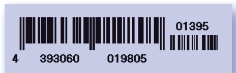
Abbildung 5: Eine EAN13-Nummer mit EAN5-Erweiterung.
